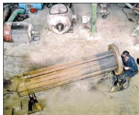
Reparation av en tvärväxlare. Balti, Moldavien.
